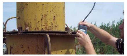
Measurement at gas wells: (Les mesures dans les puits de gaz: ) p, F, T, Q: CH4, CO2, O2, H2S, ...
